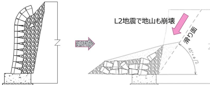
図-4 複数の小規模地震で間知石が孕みだす。 図-5 L2大地震で地山にも主動滑りが生じる。
