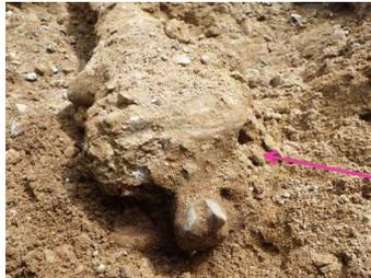
写-6 IBアンカー先端の充填状況
