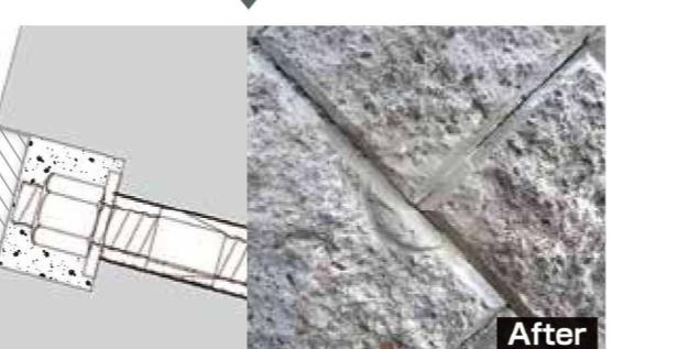
削孔・注入用ロッドに削孔用ロストビットを取り付けて所定の深さまで削孔します。削孔・注入用ロッドは孔内に残置させ、補強芯材として利用します。
